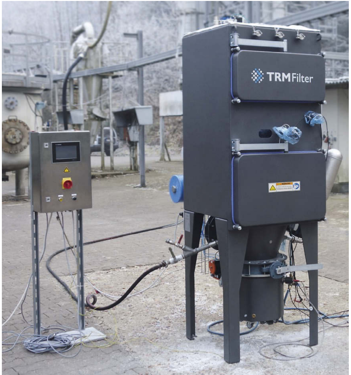
Entstaubungsanlage bei Explosionstests auf dem Versuchsgelände der FSA in Kappelrodeck.
