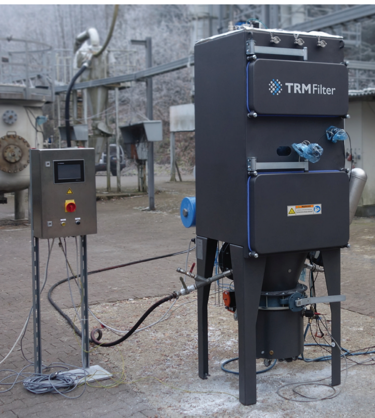
TRM-Filter-Entstaubungsanlage bei Explosionstests auf dem Versuchsgelände der FSA in Kappelrodeck.
